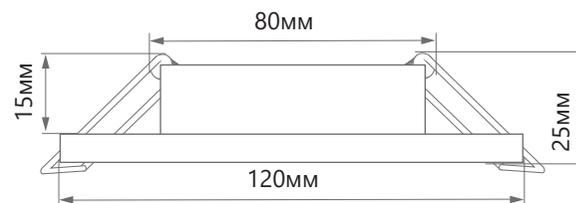
Элегантный встраиваемый светильник **DL4120** ТМ Feron украсит интерьер и предоставит возможность дополнительной подсветки помещения. Светильник может устанавливаться как в подвесные, так и в натяжные потолки. В качестве основного источника света используются лампы GX53.
